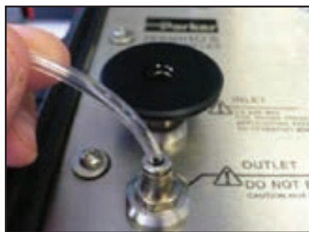
Conecte uma mangueira de SAÍDA (ø 4 mm)
