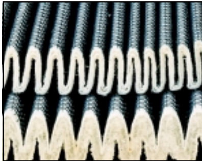
A foto acima mostra o material “seco” do filtro Par-Gel™ e o mesmo material abaixo, inchado com água absorvida.
